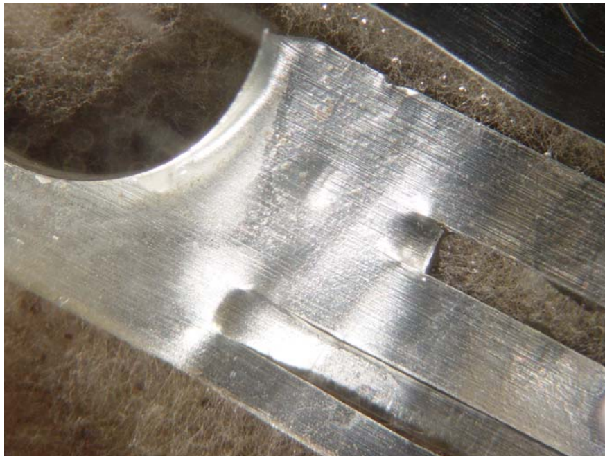
Bild 3, Verfahren B: Prüfkörper nach 4 Wochen Bebrütungszeit, kein Pilzwachstum auf dem Prüfkörper sichtbar
