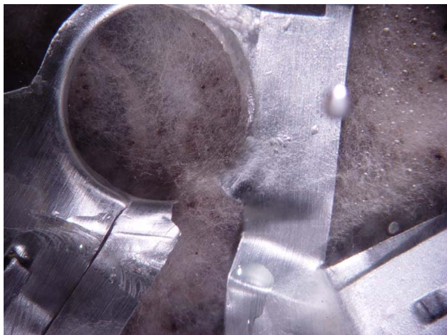
Bild 2, Verfahren B: Prüfkörper nach 4 Wochen Bebrütungszeit, kein Pilzwachstum auf dem Prüfkörper sichtbar
