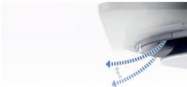
Die patentierte Luftaustrittswinkel Einstellung, von horizontal bis vertikal ohne Luftleitklappen, wird durch einen Boosterlüfter je 120° Zone bestimmt. Der Boosterlüfter saugt 0-5% (0% für vertikal | 5% für horizontal) der ausgeblasenen Luft um den Zonenauslass herum an, so dass die konditionierte Luft bei horizontaler Einstellung parallel zur Decke kommt und sich über einen Durchmesser von 12 Meter gleichmäßig verteilt.
