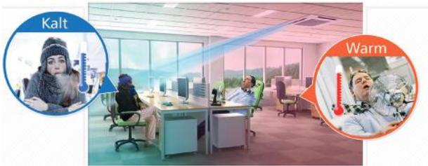
Bei konventionellen Kassettengeräten wird gekühlte Luft über 4 Luftleitlamellen in den Raum eingeblasen. Das führt zu einer ungleichmäßigen Durchkühlung des Raumes und zu einem differenzierten Temperaturempfinden. Personen, die dem direkten Luftstrom ausgesetzt sind, empfinden es als zugig und zu kalt - andere als zu warm. Die Raumzonen über Eck werden kaum vom Kaltluftstrom erfasst.
