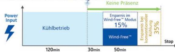
Die Luftleitlamellen werden im normalen Kühlbetrieb über den Bewegungssensor automatisch gesteuert. Sich im Raum aufhaltende Personen werden vom Sensor erfasst. Die Luftleitlamellen werden so gesteuert, dass Personen nicht direkt dem Luftstrom ausgesetzt sind. Die On/Off Funktion sorgt für die automatische Ein- und Abschaltung des Gerätes wenn sich keine Person im Raum befindet. Ideal für Büros, Praxen und Behandlungsräume. Energieersparnis bis zu 50%.
