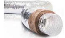
schwer entflammbar, Brandklasse B-s1,d0 (entspricht DIN 4102-B1), Temperaturbereich -30°C bis +150°C, Isolationsstärke 25 mm, TÜV geprüft.
